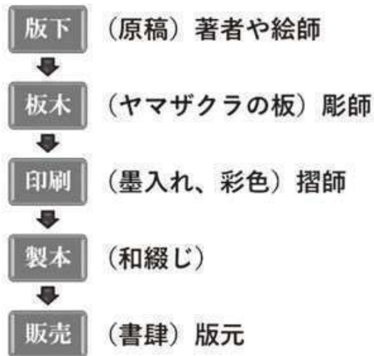
図6 江戸時代の本の製作工程
